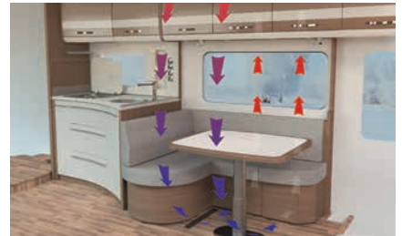
» AirPlus – perfekte Luftzirkulation im Innenraum und Hinterlüftung der Dachschränke und Anrichten
